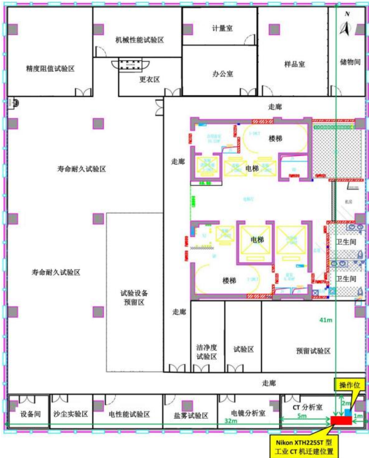
图 2-4 安培龙智能传感器产业园的 1A 栋 14 层平面布置图
